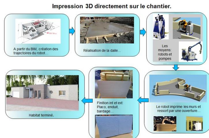
Figure 6. LES DIFFERENTES ETAPES DE NOTRE PROCEDE INNOVANT DE CONSTRUCTION.
