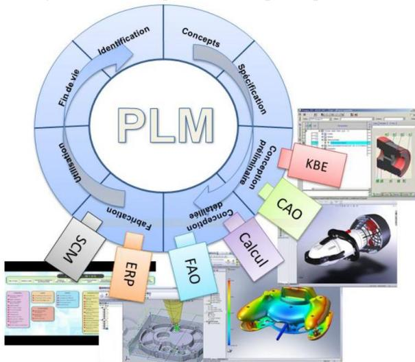
Figure 2: Système PLM et applications métier (source : [7, p. 25])
